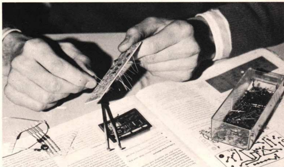
Afb. 1: Alle lage onderdelen worden als eerste door de print gestoken.
